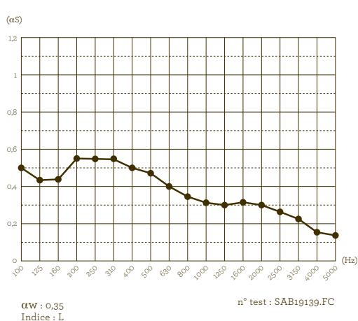
Conditions de réalisation des tests acoustiques: Panneaux de 18 mm d'épaisseur montés avec plénium de 100 mm garni de panneaux de laine de roche ISOVER DOMISOL LR d'épaisseur 30 mm et revêtus sur une face d'un voile de verre noir, isolant en contact direct avec le dos des panneaux Obersound.
