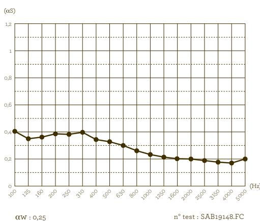
Conditions de réalisation des tests acoustiques: Panneaux de 18 mm d'épaisseur montés avec plenum de 100 mm garni de panneaux de laine de roche ISOVER DOMISOL LR d'épaisseur 30 mm et revêtus sur une face d'un voile de verre noir, isolant en contact direct avec le dos des panneaux Obersound.
